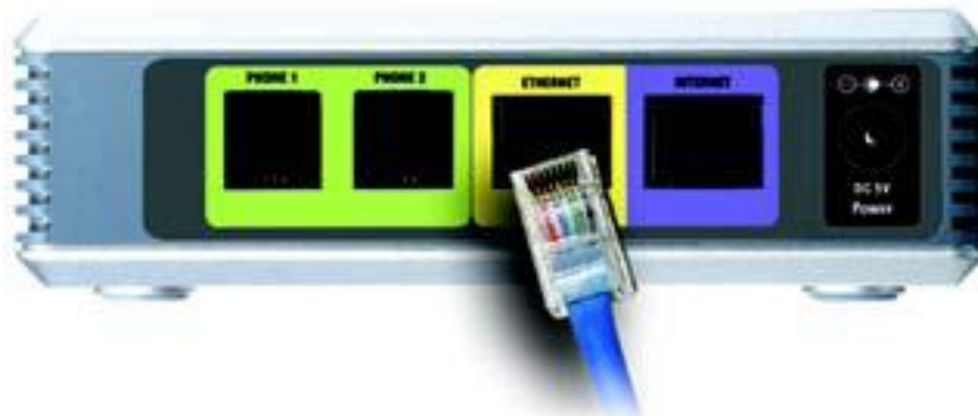
Рис.3 - Присоединение кабеля устройств локальной сети
